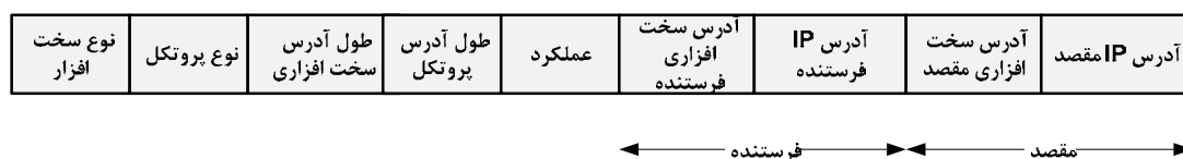
شکل (۸-۲): قالب بسته ARP
