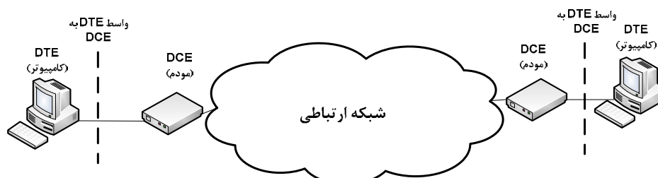
شکل (۲-۳۸): واسط DTE به DCE
