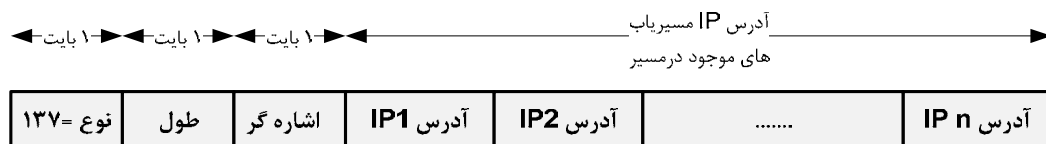
شکل (۸-۱۷): ساختار مسیریابی مبدا دقیق
