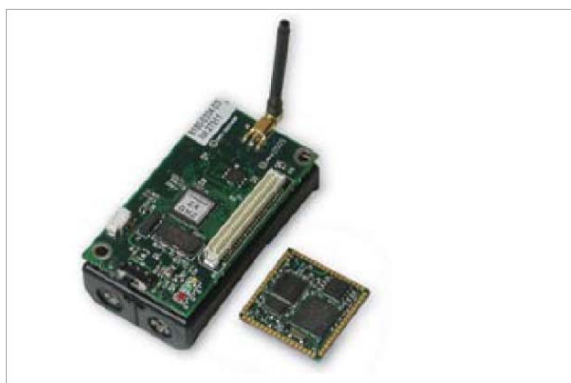
شکل (۵-۱۰): نمونه ای از گره حسگر MICAz و MICAz OEM
